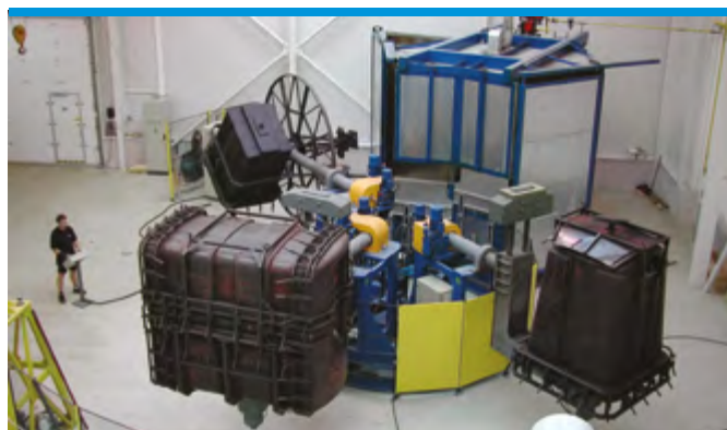
Tehnologia de fabricație - roto-formare
